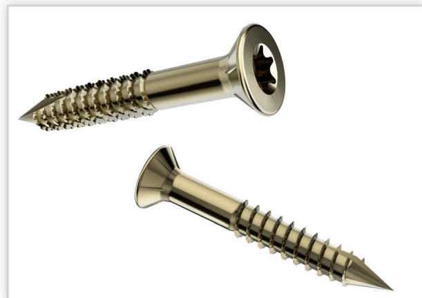
MARCOPOL, Wkręty do drewna EXTRA. Zastosowanie: specjalistyczne wkręty do wszystkich prac przy montażu konstrukcji drewnianych. Ostrze wierzące zapewnia szybki montaż w twardym drewnie, jednocześnie zapobiegając pękaniu drewna.
