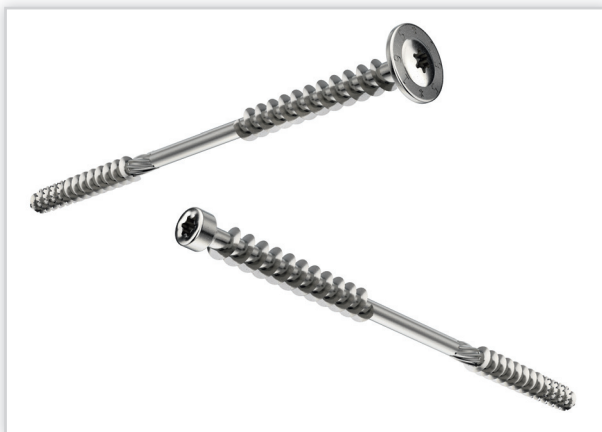
MARCOPOL, Wkręty do więźby dachowej. Zastosowanie: do wykonywania konstrukcyjnych połączeń kontrłat w systemach nakrokwiovych izolacji dachowych. Zabezpieczają nakrokwiovy materiał izolacyjny przed zgnieceniem wywołanym ciężarem pokrycia dachowego oraz obciążeniami zewnętrznymi.
